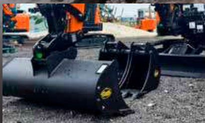
GODETS DE NIVELAGE / CURAGE
